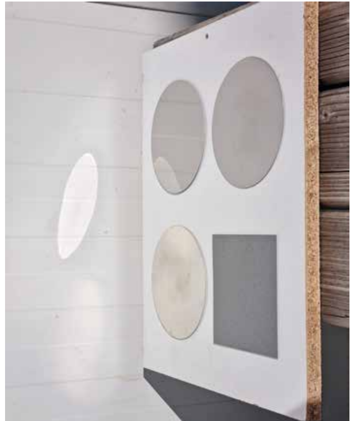
Unterschiede im Reflexionsverhalten von Edelstahl.
